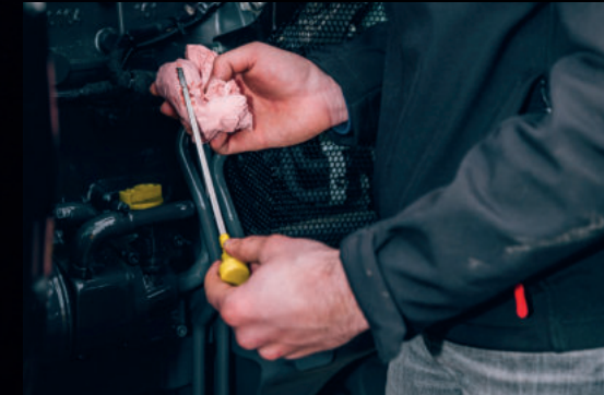
Das Design der Vorderachse und die schmale Motorhaube erleichtern den Zugang zum Ölpeilstab und zum Ölfilter.
