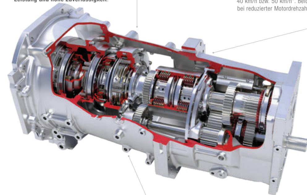
Das Dyna-6 Super Eco liefert sechs Lastschaltstufen in vier Gruppen – für hohe Bedienerfreundlichkeit im Feld und auf der Straße. Insgesamt 24 Gänge in beide Richtungen bedeuten, dass für praktisch jede Anwendung der perfekte Gang gewählt werden kann. Die Höchstgeschwindigkeit liegt bei 40 km/h bzw. 50 km/h\*. Beide werden bei reduzierter Motordrehzahl erreicht.
