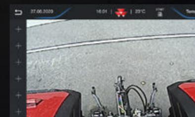
▶ **Kamera-Modus\*** – Bilder einer Rückfahrkamera können auf dem Bildschirm dargestellt werden. Dies kann der Fahrer nutzen, um den Einsatz komplexer Arbeitsgeräte zu überwachen oder um die Sicherheit beim Rückwärtsfahren zu erhöhen.
