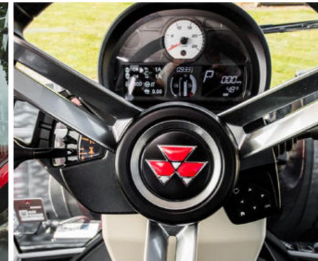
**NEUES ARMATURENBRETT MIT SIS – SETUP UND INFORMATION SCREEN:** Die Fahrer werden das schlanke Armaturenbrett zu schätzen wissen, auf dem alle Betriebsdaten und Einstellungsmöglichkeiten auf einem Farbbildschirm im Format 70 × 52 mm dargestellt sind.
