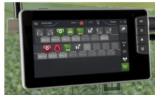
**DAS VORGEWENDE-MANAGEMENT** kann bei der Version Exclusive über das Terminal Datatronic 5 ganz bequem automatisch gesteuert werden (optional auch bei Version Efficient) ...
