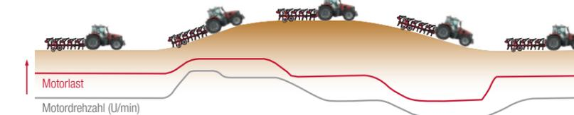
Das renommierte stufenlose Dyna-VT Getriebe verfügt nun auch über einen neuen Automatikmodus. Dies erlaubt dem Fahrer, mithilfe des MultiPad-Fahrhebels oder des Fußpedals die Fahrgeschwindigkeit zu verändern, während abhängig von Last und Geschwindigkeit automatisch die optimale Motordrehzahl ausgewählt wird. Dies ermöglicht ein besonders geschmeidiges Arbeiten und erhöht die Kraftstoffeffizienz.
