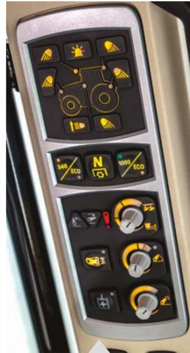
Bedienelemente für Zapfwelldrehzahl und EHR Einstellungen in der Kabinensäule.
