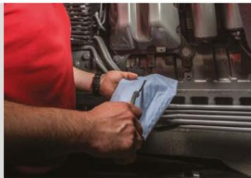
Der Luftfilter des Motors ist bequem zugänglich und leicht zu reinigen. Bis zu 90 Prozent der Schmutzpartikel der angesaugten Luft werden bereits vor dem Motorluftfilter abgesaugt.
