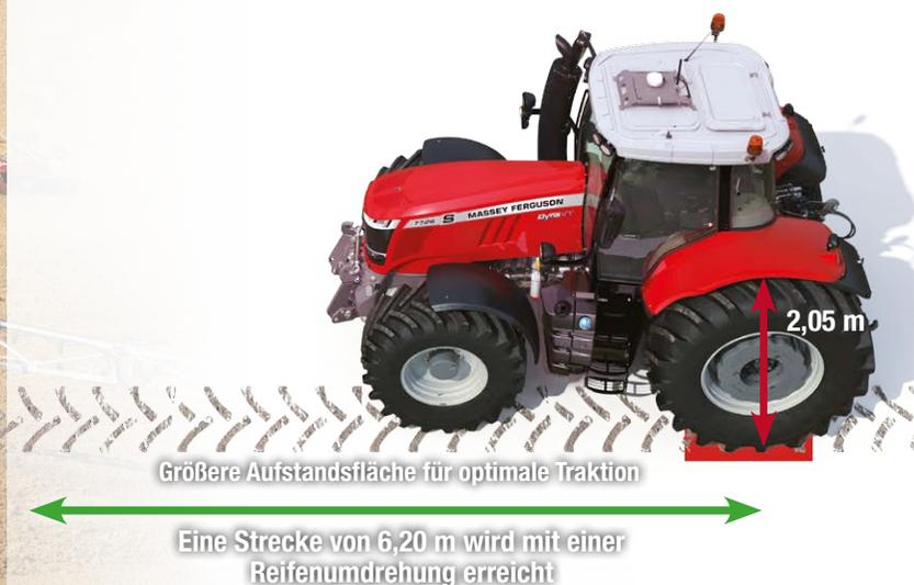
Größere Aufstandsfläche für optimale Traktion
