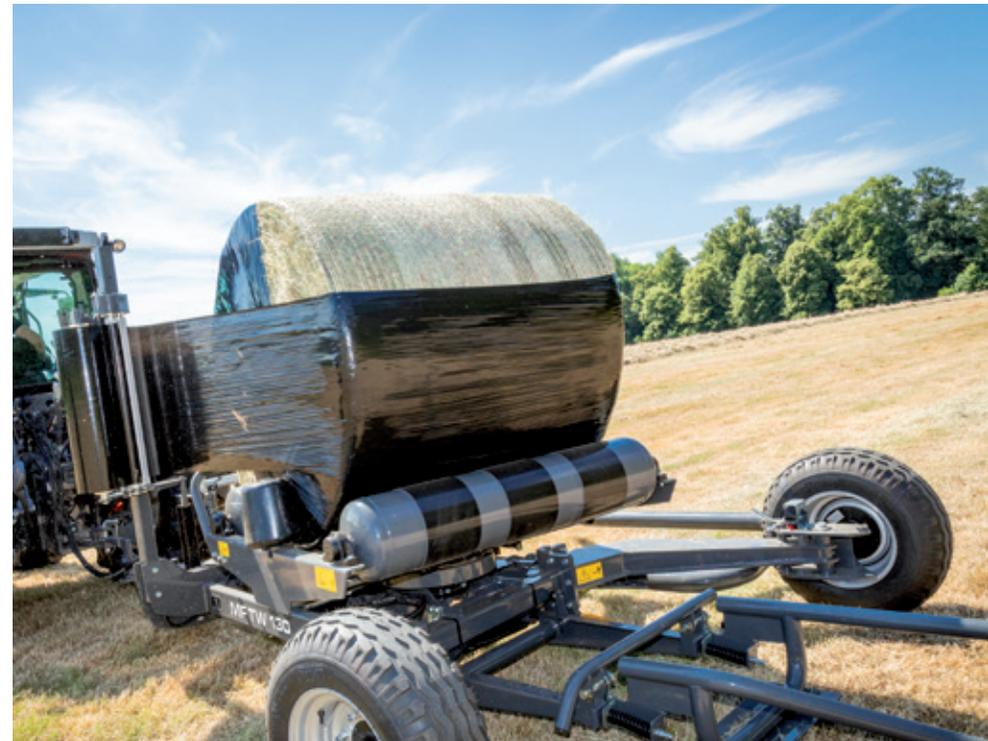
Durch einfaches Anheben des Wicklers mit dem Ladearm kann das rechte Transportrad um die Mittelspindel nach außen geschwenkt werden, wodurch sich die Maschinenbreite für maximale Standsicherheit von 2,55 auf 2,85 m erhöht.
