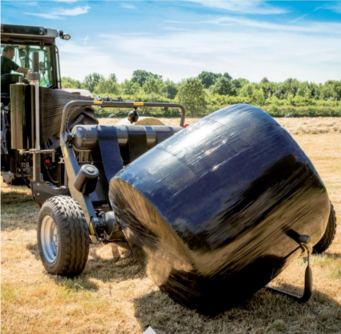
Dank des niedrig positionierten Wickeltisches, der sich beim Entladen der Ballen weit zum Boden hin neigt, erfolgt der Auswurf der Ballen äußerst sanft und ohne die Folie zu beschädigen. Ein optional erhältlicher Ballenkipper verhindert das Wegrollen der Ballen bei Gefälle – dies erhöht die Sicherheit und verringert den Zeitaufwand beim Einsammeln der Ballen im Feld.
