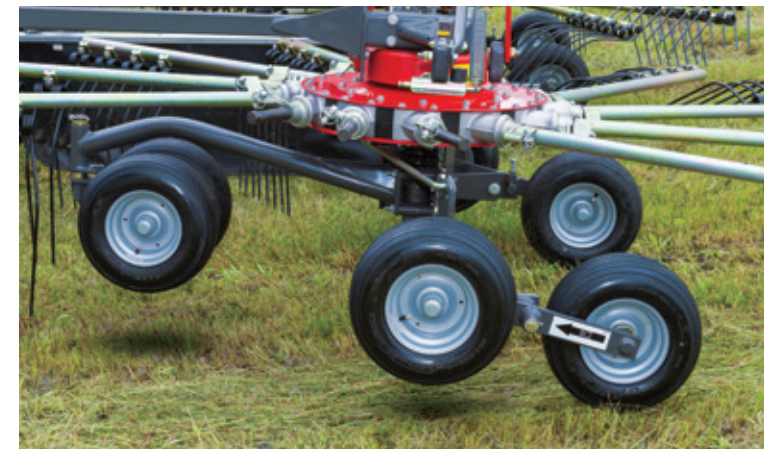
Patentierte, komplett kardanische Kreiselaufhängung
