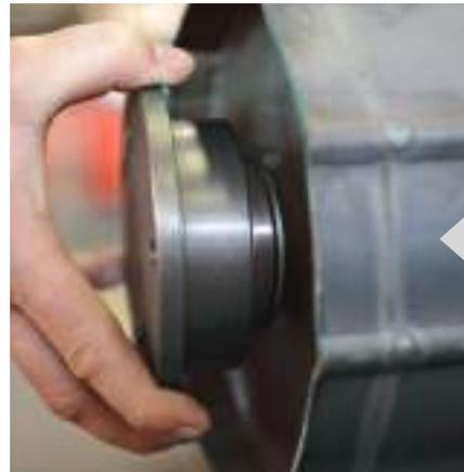
Das intelligente Design der Lagergehäuse ermöglicht ein gewisses Spiel der Walzen, sodass axiale Lastspitzen während des Pressens eliminiert werden.
