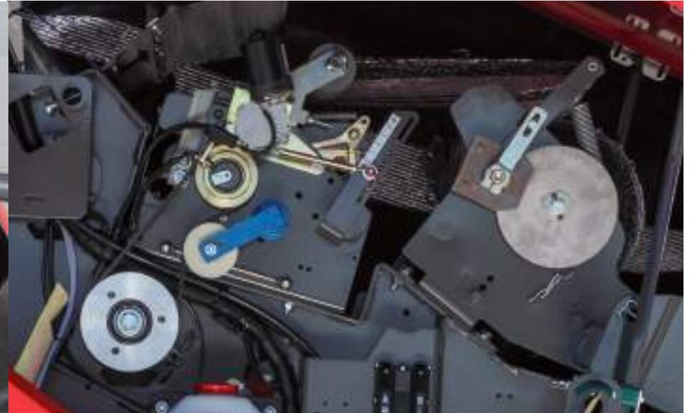
Dank des serienmäßigen **Easy Loading Systems (ELS)** kann eine Ersatznetzrolle problemlos auf der Presse transportiert werden. Die Rollen sind innerhalb von wenigen Minuten gewechselt, wodurch die produktive Arbeitszeit erhöht und der Durchsatz gesteigert wird.
