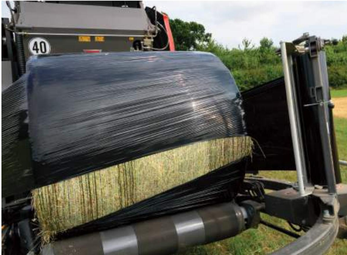
Der hydraulisch betriebene Wickeltisch besteht aus zwei Rollen und drei Endlosriemen auf einem geschweißten Rahmen, was eine noch bessere Langlebigkeit bietet. Ein Sensor unterhalb des mittleren Riemens stellt sicher, dass der Wickelvorgang erst beginnt, wenn der Ballen korrekt auf dem Tisch platziert wurde, während vier lange seitliche Stützrollen den Ballen beim Wickeln in der Mitte halten.
