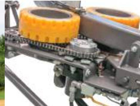
Der Wickelring wird von zwei großen Gummrollen angetrieben. Das sorgt für eine große Kontaktfläche, Vermeidung von Schlupf und ein äußerst geringes Geräuschniveau.
