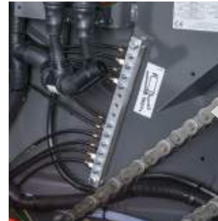
Eine regelmäßige und ausreichende Schmierung der Walzenlager ist überaus wichtig, insbesondere bei schwierigen Bedingungen, d. h. zum Beispiel beim Pressen von Silage. Daher ist die Ballenpresse mit zentralen Schmierblöcken ausgestattet, die an gut zugänglichen Stellen positioniert sind und somit eine einfache und schnelle Wartung ermöglichen.
