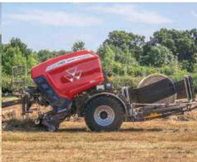
Zur Sicherstellung eines sanften Ballenauswurfs wird der Wickeltisch abgesenkt, was die Rotationsgeschwindigkeit des Ballens minimiert und somit eine Beschädigung der Folie verhindert, während zugleich die ideale Ballenform aufrechterhalten wird. Der optionale Ballenkipper legt die Ballen auf der Kante ab, verhindert so ein Wegrollen der Ballen und erleichtert das Beladen des Anhängers. Der Fahrer kann zudem zwischen einem automatischen und einem manuellen Entlademodus wählen.
