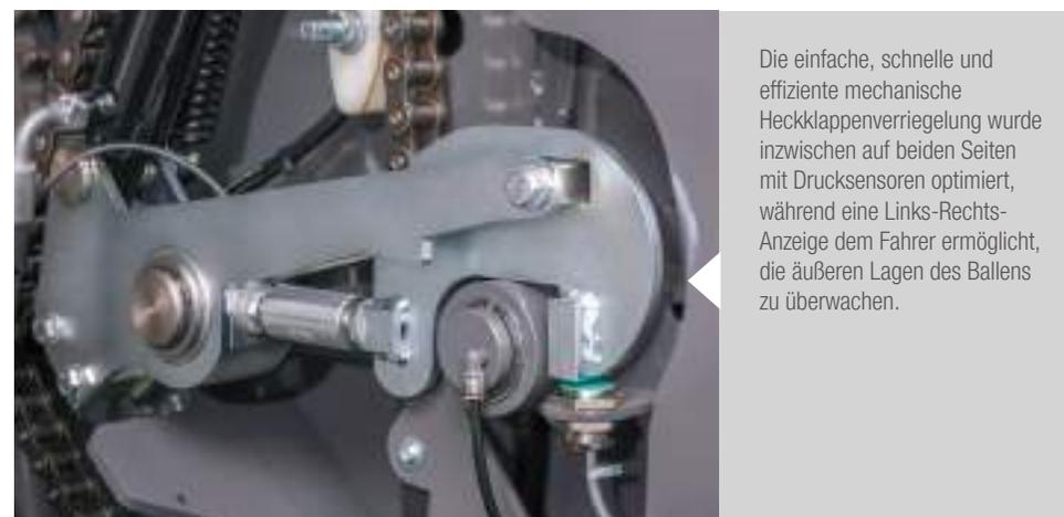
Die einfache, schnelle und effiziente mechanische Heckklappenverriegelung wurde inzwischen auf beiden Seiten mit Drucksensoren optimiert, während eine Links-Rechts-Anzeige dem Fahrer ermöglicht, die äußeren Lagen des Ballens zu überwachen.
