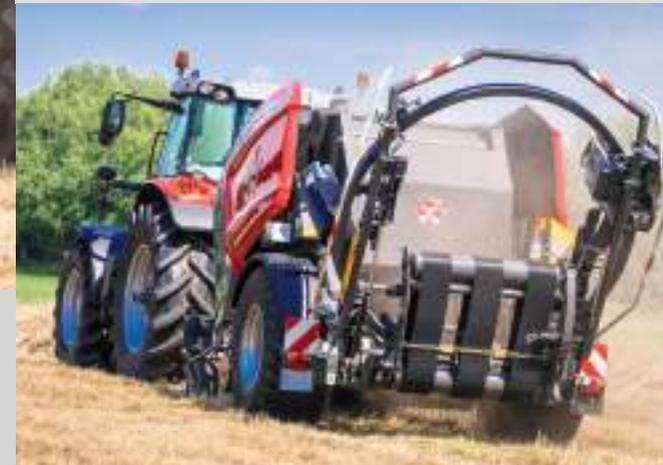
Für die Transportstellung wird der Wickeltisch nach vorne geklappt, wodurch die Gesamtlänge der Maschine auf nur 5,90 m verringert wird und so ein sicherer Transport und optimale Wendigkeit sichergestellt werden.
