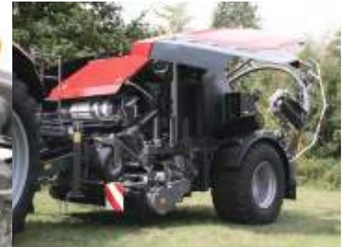
An beiden Seiten der Ballenpresse befinden sich in bequemer Höhe zwölf Folienrollenhalter und mit zwei zusätzlichen am Wickler installierten Rollen wird die Effektivität auf dem Feld weiter gesteigert.
