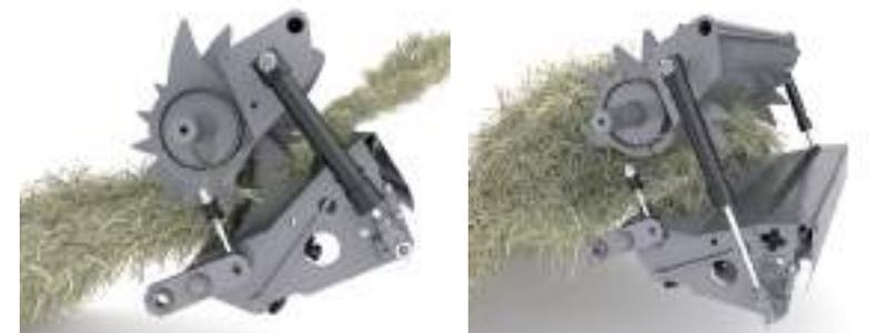
Im Falle einer Verstopfung kann der Fahrer den Förderkanalboden problemlos öffnen und die Messer gleichzeitig absenken, um ausreichend Platz zu bieten, damit das Material hindurchgelangt.
