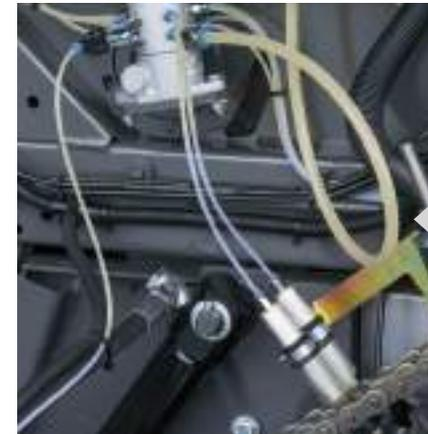
Die automatische Ketten-schmierung ermöglicht eine individuelle Anpassung für jede Kette und gewährleistet stets eine optimale Ölzufuhr, wodurch die Wartungszeit verringert und die Lebensdauer der Ketten verlängert wird. Für maximale Langlebigkeit werden bei den Ballenpressen ausschließlich Ketten von höchster Qualität verwendet.
