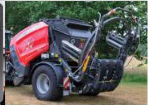
Die Wickeleinheit kann hochgeklappt werden, um einen sicheren und komfortablen Transport von Feld zu Feld zu ermöglichen.
