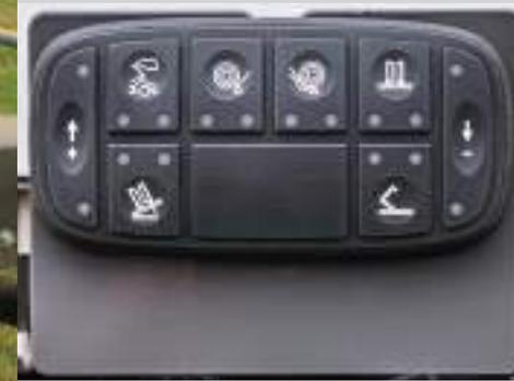
Ein externes Bedienpult im hinteren Bereich der Ballenpresse ermöglicht die Steuerung der Heckklappe, des Wickelrings, des Tisches und der Folienhalter – für bequemen Rollenwechsel sowie einfache Wartung und Reinigung.
