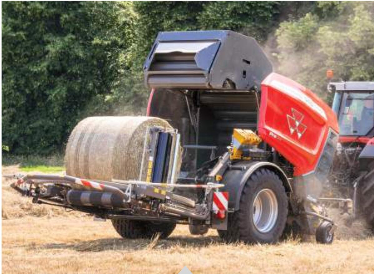
Die neue Kombination weist einen flacheren Winkel des Gutstroms auf, was zu einer niedrigeren Gesamthöhe der Presse führt. Dies steigert die Fahrstabilität und ermöglicht somit einen sichereren und schnelleren Einsatz an Hängen. Darüber hinaus wird auch der Gegendruck im Zuführbereich reduziert, was den Materialfluss optimiert und das Risiko einer Blockade minimiert.
