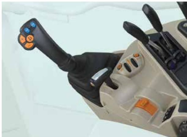
Die Bedienelemente der „Essential“-Kabine in einem 4-Zylinder MF 5600 mit elektronischem Frontlader-Joystick
