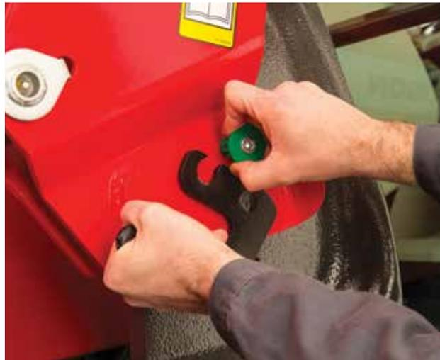
Arretierung lösen, dann Bolzen drehen und ziehen
