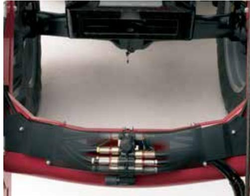
Das Querrohr nimmt Hydraulikkomponenten auf und sorgt für Stabilität
