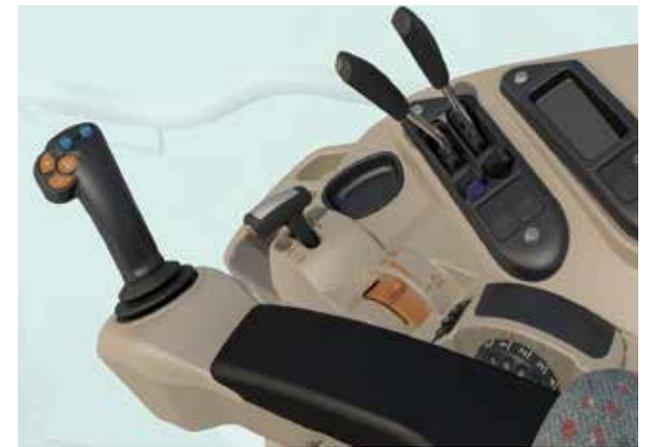
Kabinenoption Efficient mit elektrohydraulischem Multifunktions-Joystick komfortabel auf der Armlehne
