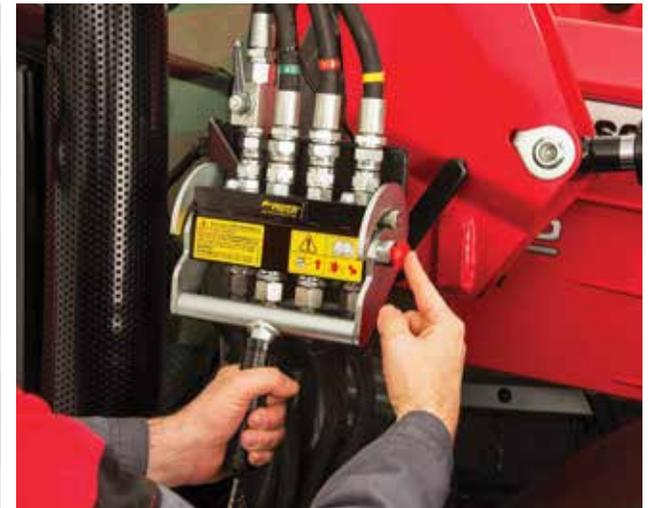
Hydraulische und elektrische Verbindungen trennen
