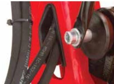
Die Hydraulikleitungen sind durch die Hubarme verlegt, um sie vor Beschädigungen zu schützen.
