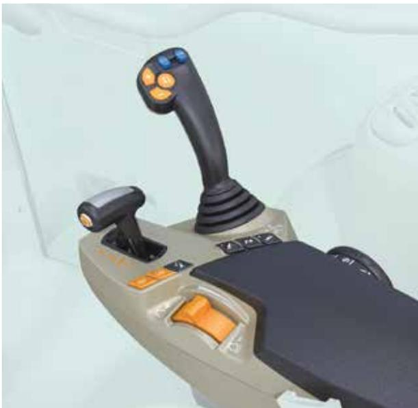
Kabinenoption Exclusive mit MultiPad-Hebel und elektrohydraulischem Multifunktions-Joystick (auf der rechten Seite)
