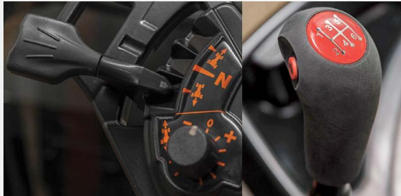
Der optionale, linkshändig bedienbare, PowerShuttle-Hebel erlaubt in Kombination mit dem hochmodernen Getriebe das kinderleichte Wechseln der Fahrrichtung Vorwärtsfahrt, Rückwärtsfahrt und Leerlauf. Zur Steigerung des Fahrkomforts lässt sich das Ansprechverhalten der Wendeschaltung mithilfe des ComfortControl-Drehreglers anpassen – die ultimative Kombination beim Frontladereinsatz.
