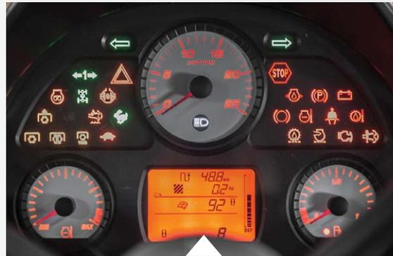
Das moderne Armaturenbrett zeigt Motor- und Zapfwelldrehzahl, abgespeicherte Motordrehzahlen, Kraftstoffverbrauch, Öltemperatur, zurückgelegte Entfernungen, bearbeitete Fläche, Betriebsstunden des Traktors sowie Wartungsintervalle und sonstige Wartungsinformationen.
