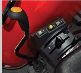
**PowerShuttle** Optionale elektrohydraulisch gesteuerte Wendeschaltung mit ComfortControl.
